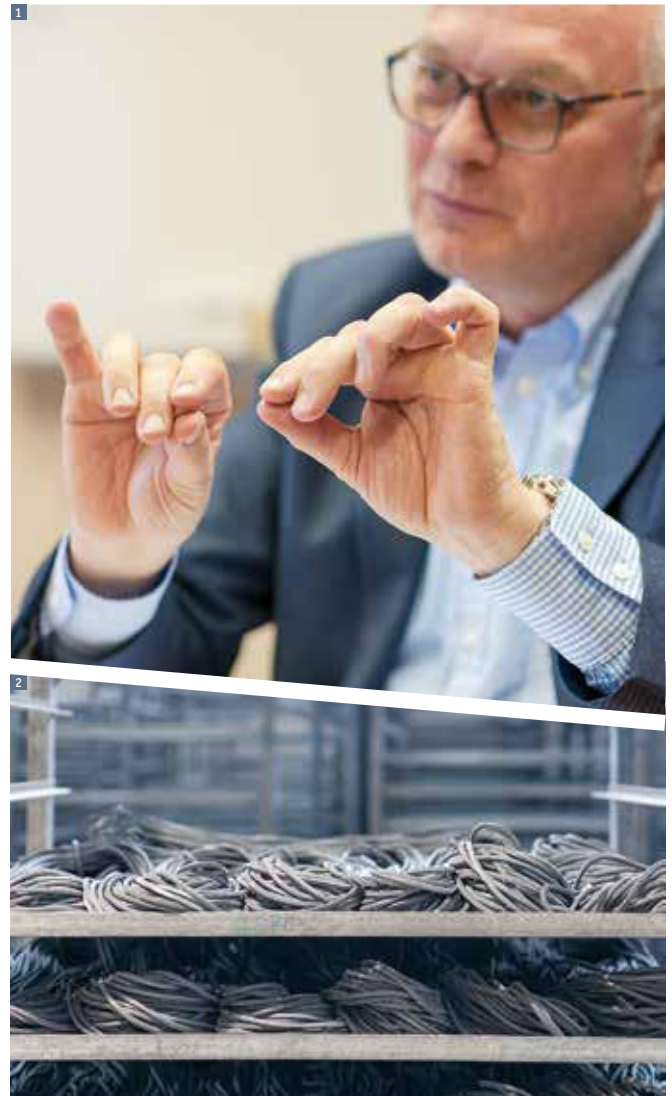
1 Vertriebsleiter Martin Richartz: „Wir bieten nahezu alles, was mit Silikonelastomeren zu tun hat.“ 2 Die vulkanisierten Extrudate werden zum Tempern auf Lochblechen abgelegt.
