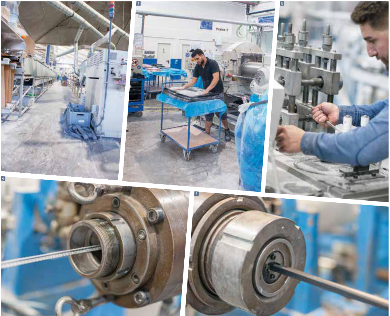
1 Auf insgesamt elf Extrusionslinien wird ein breites Sortiment an Schläuchen und Profilen hergestellt. 2 Die Herstellung der Gummimischungen erfolgt auf vier Walzwerken und einem Innenmischer im eigenen Haus. 3 Einige der Extrusionsanlagen werden fünf- bis sechsmal am Tag umgerüstet. 4 + 5 Das Extrudieren mit Metalleinlagen ist eine der Spezialitäten bei M+S.
