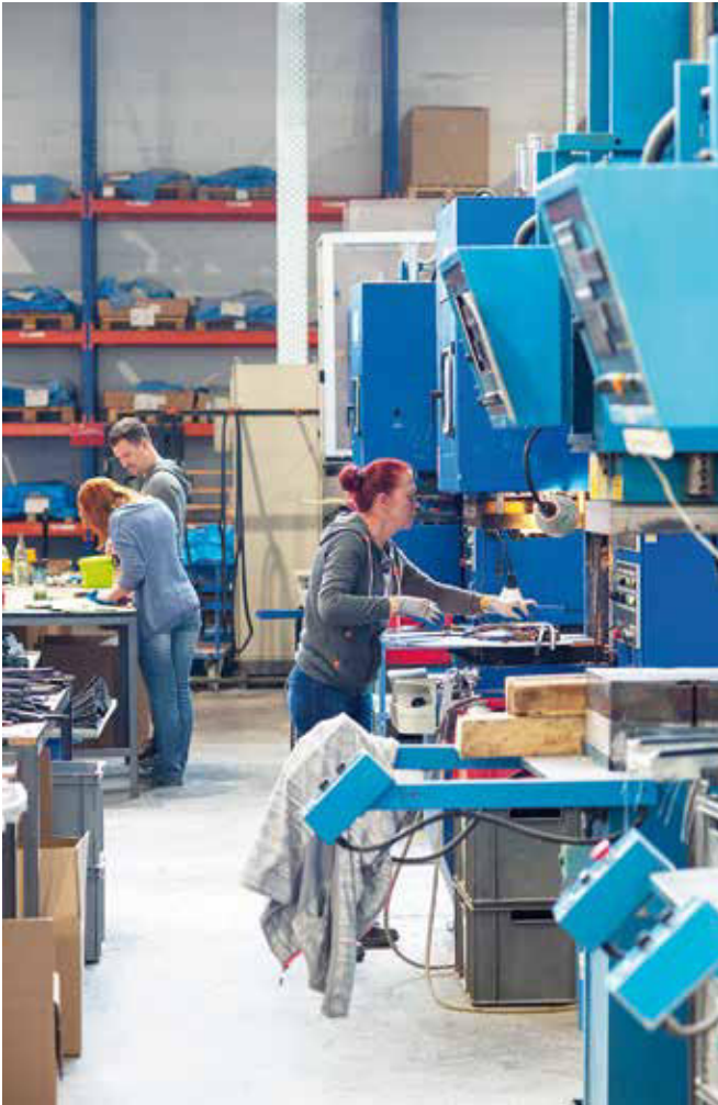
Per Eckenvulkanisation werden auf den Spritzgießmaschinen Profile zu Rahmen komplettiert.
