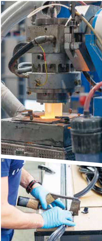
1 Bei der Senkrecht-Extrusion sorgt eine Schocktemperierung auf kurzer Strecke für die sofortige Konturgebung. 2 Zu den vielfältigen Nachbearbeitungsschritten gehört auch das manuelle Ablängen von Profilen.
